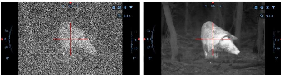
*Пример:* Изменение температуры, непрерывный просмотр конкретного теплового объекта, резкая смена параметров окружающей среды, всё это может стать причиной ухудшения изображения.
