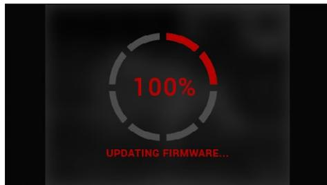
10. Удалите файл прошивки с карты памяти microSD после завершения процесса. В противном случае, система будет пытаться обновлять прошивку каждый раз при включении прицела.
