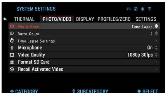
Для изменения определённого значения, необходимо выполнить следующие действия. Выберите нужный подраздел при помощи колеса прокрутки. Для выбора определённого значения нажмите кнопку ОК (после выбора оно станет красного цвета).
