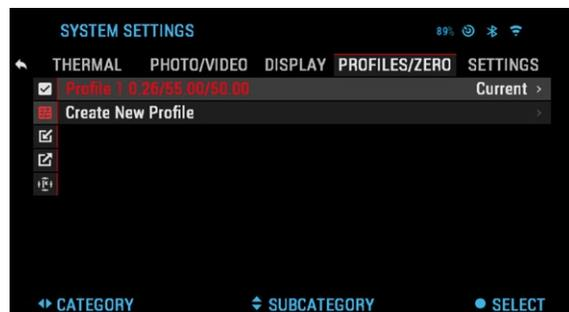
Mars 4 имеет встроенный баллистический калькулятор, который позволяет вашему оптическому прибору легко рассчитать траекторию полёта пули до цели. Для начала, при использовании этой функции, вам нужно будет ввести соответствующую информацию в используемый профиль баллистического калькулятора.
