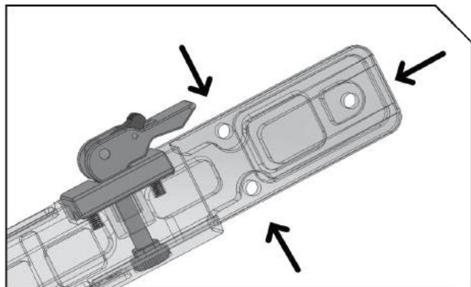
3. Расположить прибор на планке на расстоянии, обеспечивающем комфортное удаление окуляра
