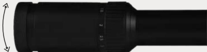
Посмотрите в окуляр на освещённый светлый предмет, поворачивайте окуляр по часовой стрелке до тех пор, пока изображение сетки не станет чётким.
