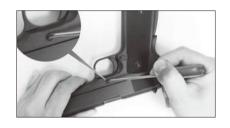
4. Потяните за затворную задержку с левой стороны затвора, чтобы снять затвор.
