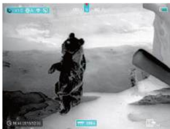
Рис. 9. Информация на экране при активном дальномере.
