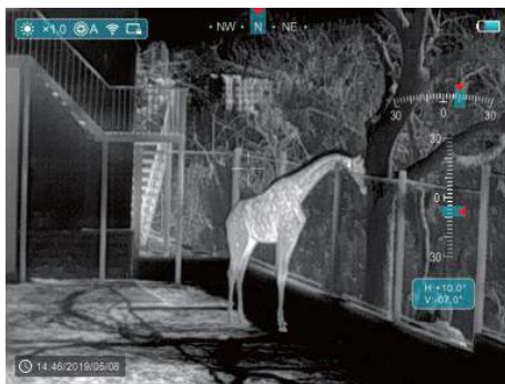
Рис. 10. Интерфейс режима угломера.
