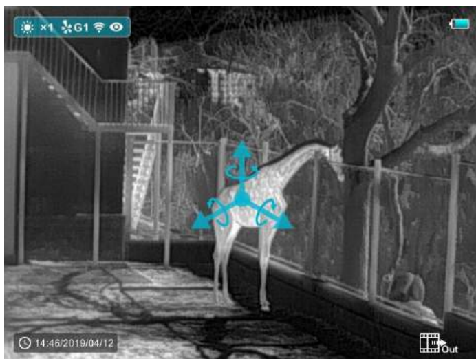
Рис. 11. Интерфейс режима калибровки компаса.
