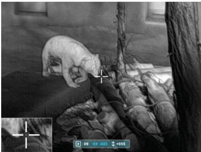
Рис. 12 Интерфейс коррекции «битых» пикселей.
