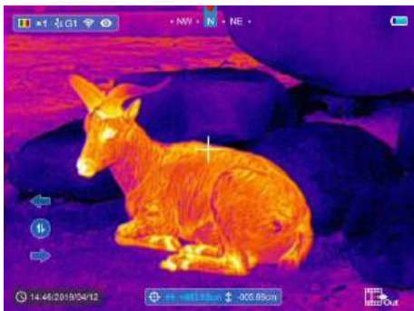
Рис. 10. Интерфейс режима пристрелки.
