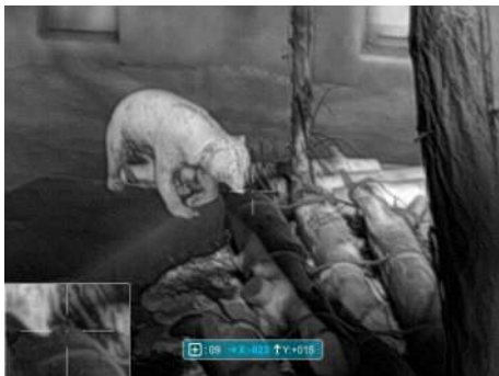
Рис. 14. Интерфейс функции коррекции «битых» пикселей.
