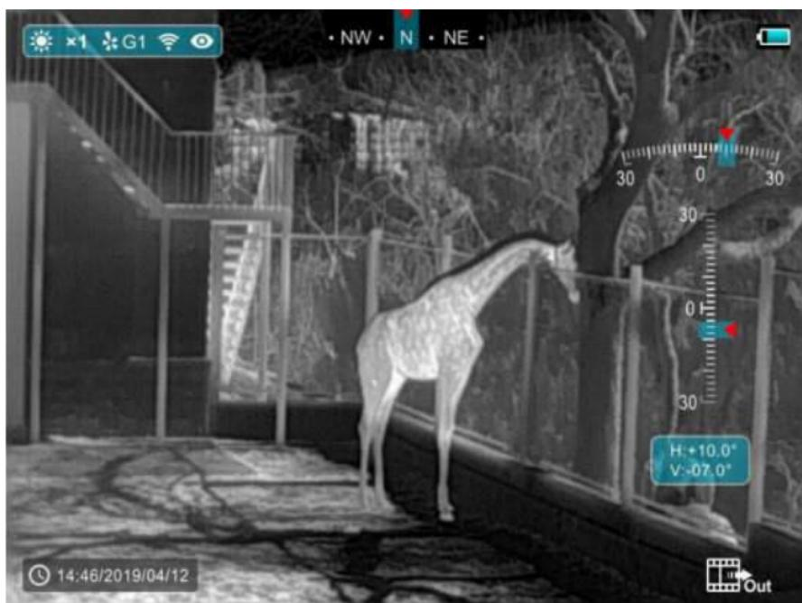
Рис. 13. Интерфейс режима угломера.
