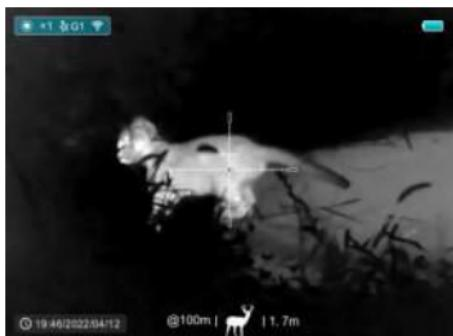
Рис. 15. Фиксированный дальномер.
