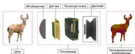
Рис. 1. Схема формирования изображения тепловизором.
